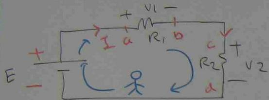
$$(-E) + (+V_1) + (+V_2) = 0$$
