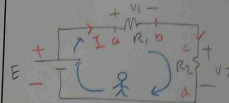
$$(-E) + (+V_1) + (+V_2) = 0$$
