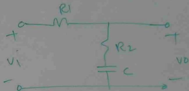
BY INSERTING  $R_2$ , THE ATTENUATION LEVEL OF HIGH FREQUENCY IS LIMITED
